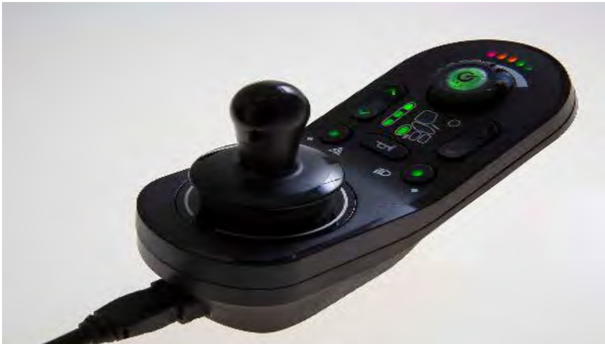
Mando del sistema LiNX para la silla de ruedas (Foto: Invacare España)
