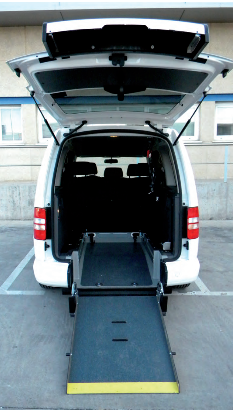
Vehículo Total Ramp con la rampa desplegada Foto: Rehatrans
